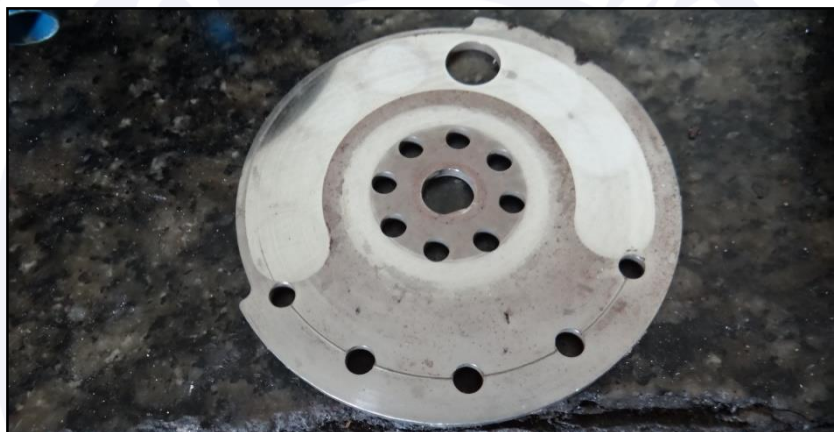
Figura 10 - Face do disco da válvula seletora de combustível com área limpa.
