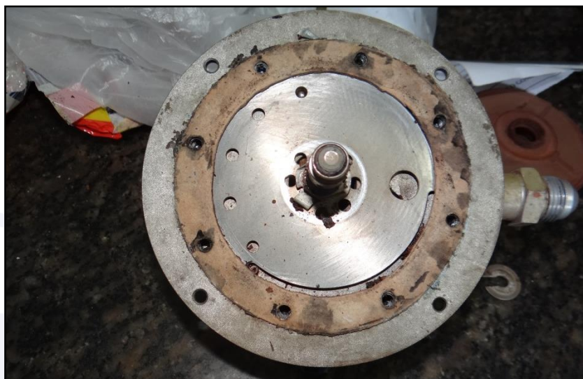
Figura 9 - Disco interno da válvula seletora de combustível na posição fechada.
