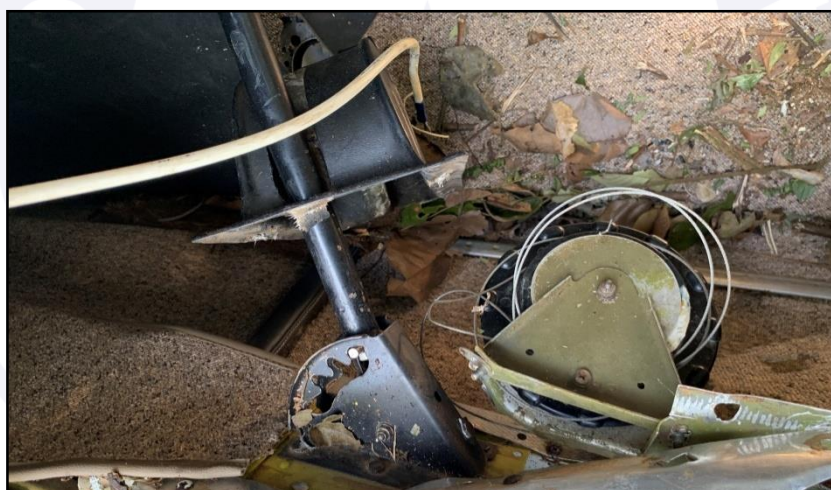
Figura 12 - Vista da alavanca de comando dos flapes na posição 40 graus.
