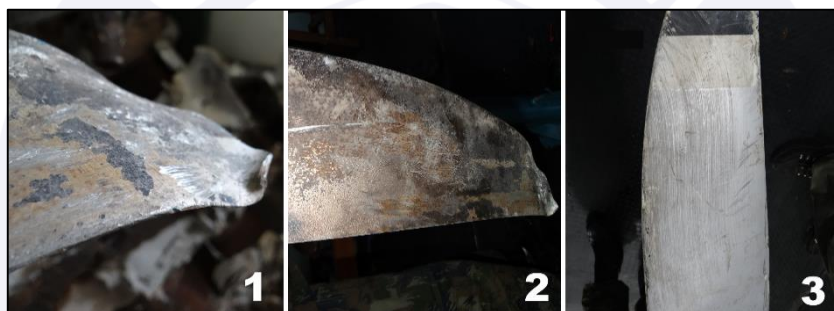
Figura 14 - Vista de dobramentos voltados para a frente na extremidade de duas pás e riscos longitudinais na terceira.
