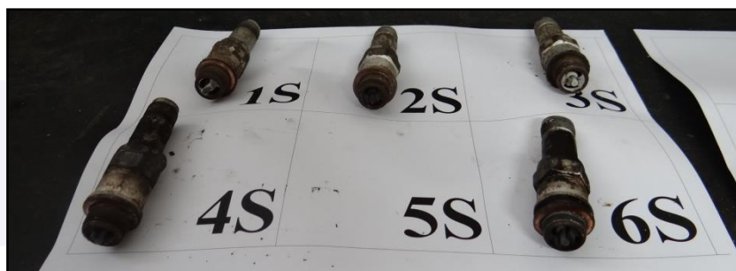
Figura 13 - Vista dos ignitores superiores dos cilindros 1, 2, 3, 4 e 6.
