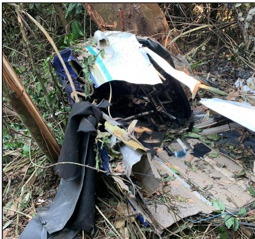
Figura 7 - Estrutura frontal da cabine com o painel da aeronave.
