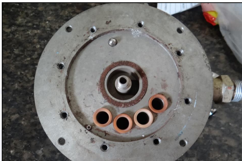
Figura 11 - Vista geral dos orifícios de comunicação da válvula seletora de combustível com os tanques de combustível da aeronave.
