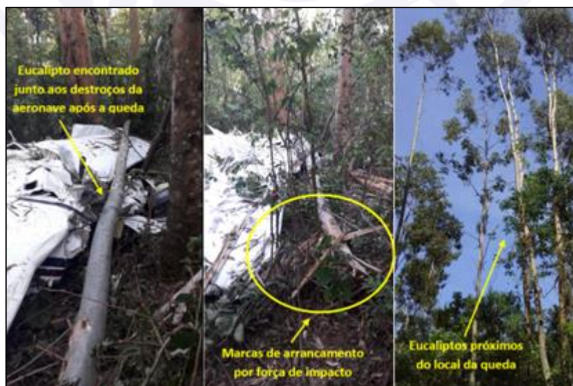
Figura 2 - Tronco de eucalipto encontrado sobre a parte inferior da aeronave.
