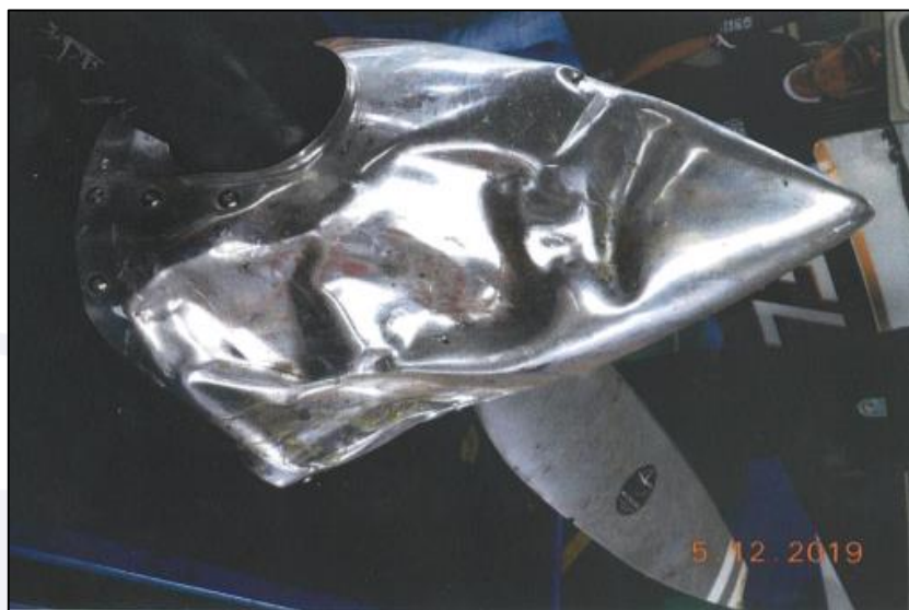
Figura 8 - Spinner com deformações por compressão.
