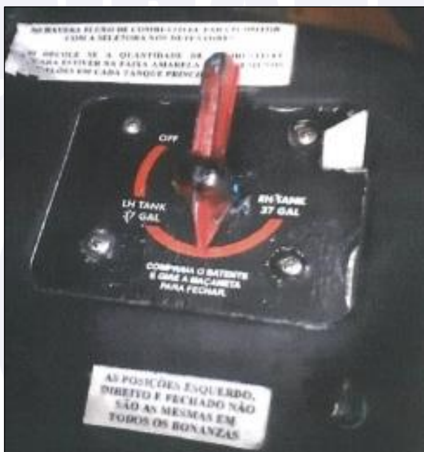
Figura 7 - Chave seletora de combustível em posição intermediária.
