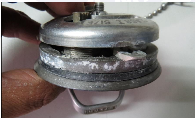
Figura 2 - Condição da gaxeta de vedação da tampa.
