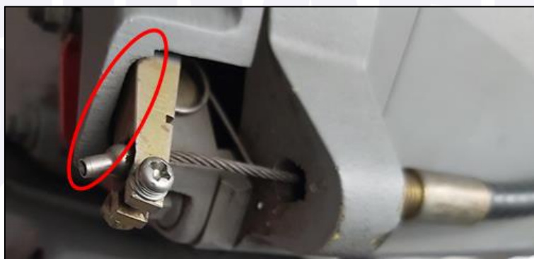
Figura 4 - O círculo vermelho mostra que não havia ajuste de folga como requerido na alavanca de acionamento mecânico.
