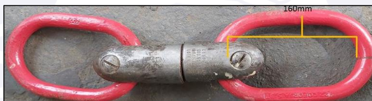
Figura 2 - Argolas idênticas às utilizadas para o enganchamento da carga externa na ocasião da ocorrência. As linhas amarelas indicam a medida interna da argola.
