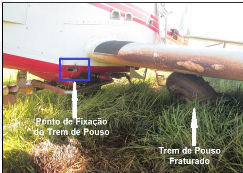
Figura 6 - Imagem do trem de pouso esquerdo fraturado.
