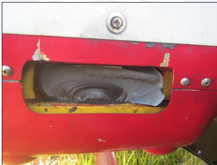
Figura 7 - Detalhe da região da quebra do trem de pouso.
