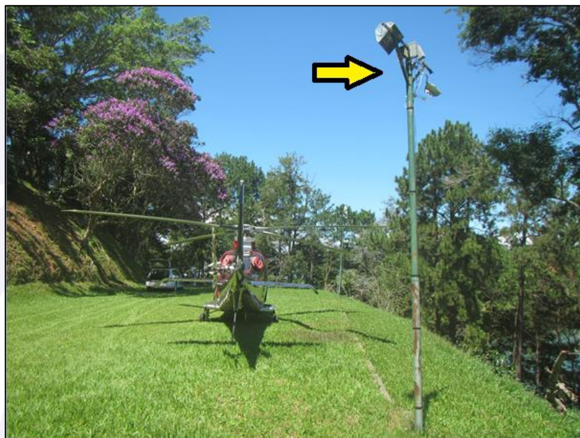
Figura 1 - Posição final após a ocorrência e destaque para o poste de iluminação atingido pelo rotor de cauda.
