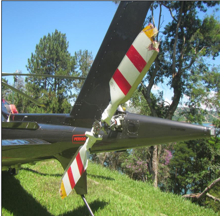
Figura 3 - Detalhe dos danos ao rotor de cauda.
