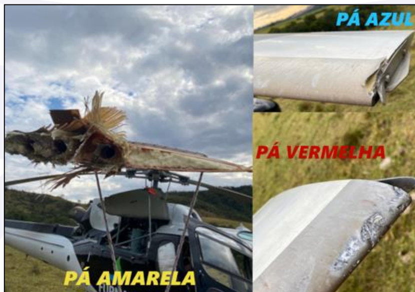
Figura 2 - Danos nas pás do rotor principal.
