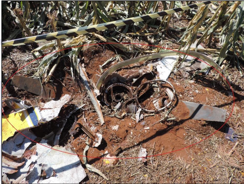
Figura 7 - Vista do ponto onde a hélice ficou enterrada.
