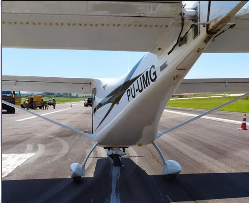
Figura 1 - Vista traseira da aeronave com o trem auxiliar quebrado.
