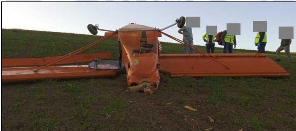
Figura 2 - Posição de parada da aeronave após pilonar com vista da hélice.
