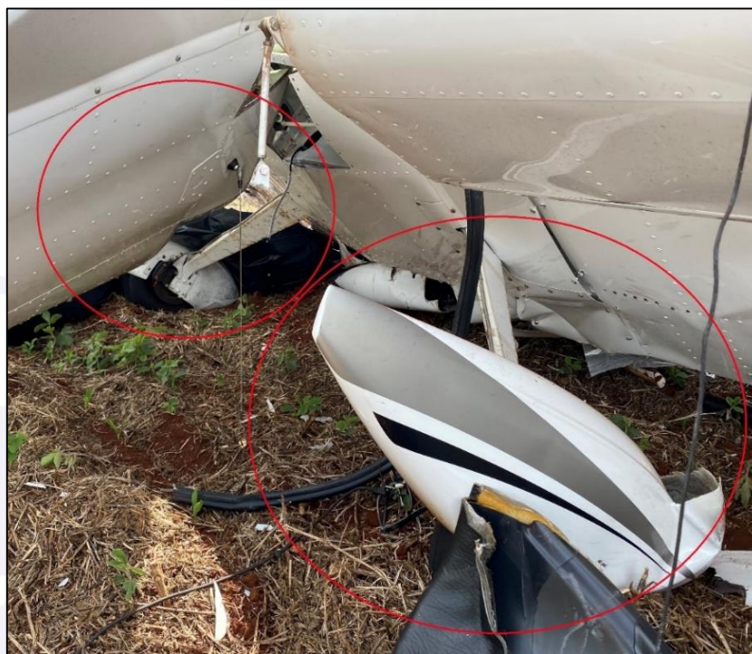
Figura 7 - Condição dos trens principais após impacto.
