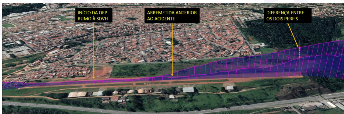
Figura 6 - Vista oblíqua em SDTB, do perfil de decolagem rumo à SDVH e da arremetida anterior ao acidente. Detalhes do ponto de início de decolagem, ponto de início do segmento de subida da arremetida e diferença vertical entre os dois perfis.
