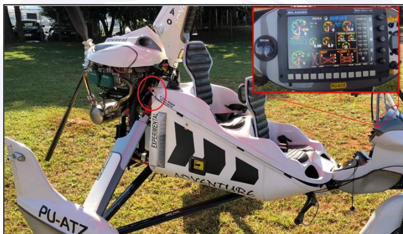
Figura 2 - Aeronave PU-ATZ com destaque para a chave de corte de emergência da ignição e o EFIS.
