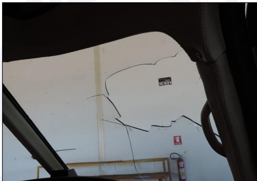
Figura 1 - Visão interna do para-brisas direito danificado pelo impacto contra o urubu.
