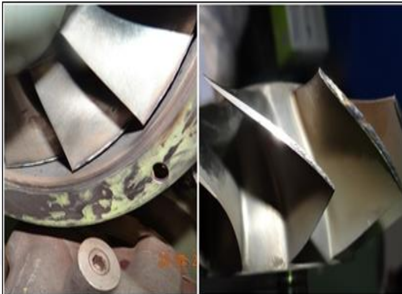
Figura 5 - Marcas de roçamento observadas nas pás do estágio axial do compressor.
