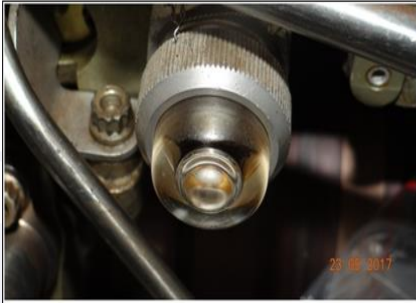
Figura 4 - Vista do indicador de pré-obstrução na condição de repouso.
