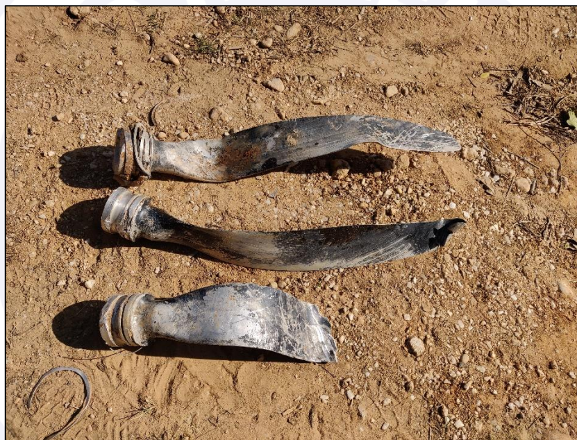
Figura 2 - Pás da hélice com torções e rupturas típicas de impacto com potência.
