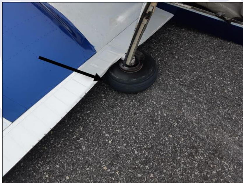
Figura 4 - Trem de pouso projetado para trás.
