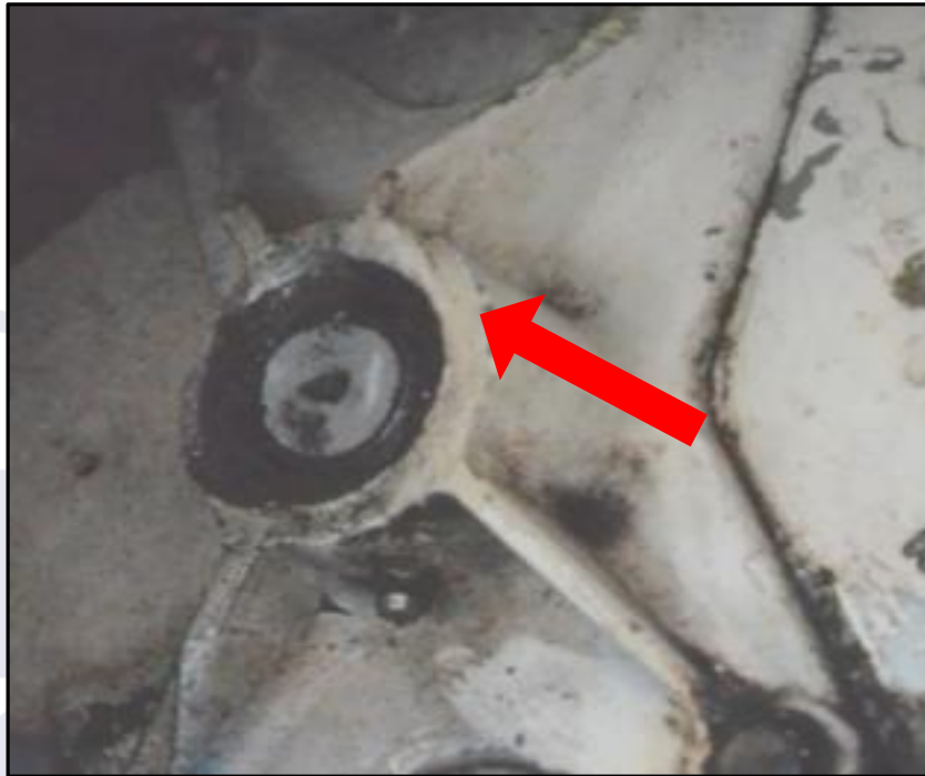
Figura 3 - Imagem do pino e parafuso fraturados dentro do alojamento traseiro.
