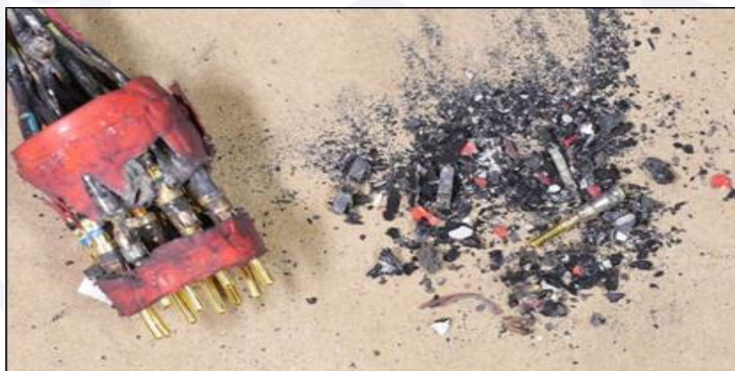
Figura 29 - Material fragmentado da desmontagem do conector D7232P.
