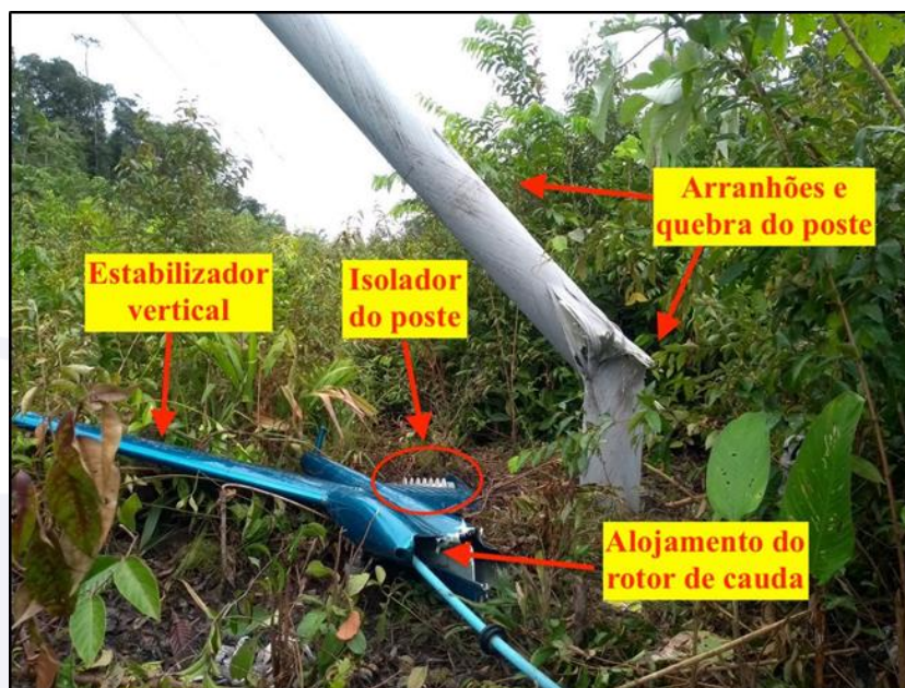
Figura 8 - Estabilizador vertical da aeronave ao lado do poste quebrado pelo impacto.
