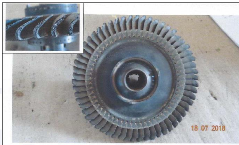
Figura 8 - Imagens do rotor da turbina do compressor. O destaque mostra uma vista superior do topo das palhetas, onde parte do material foi derretido.
