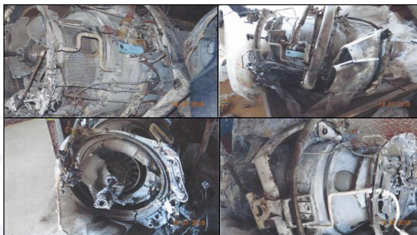
Figura 6 - Imagens do motor, nas quais se observa os danos às partes laterais e traseira resultantes da ação do fogo.
