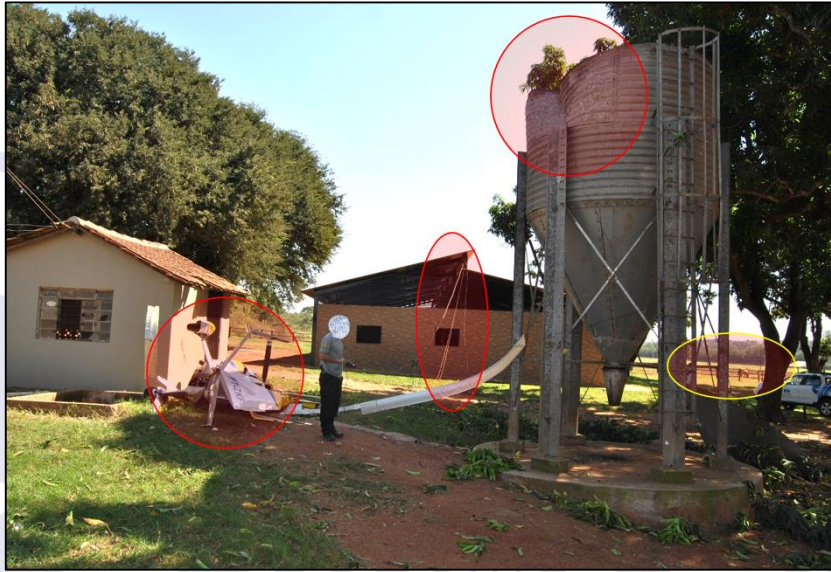
Figura 4 - Posição final do girocóptero, folhas no solo cortadas pelo impacto contra a árvore, caixa d'água com marcas de colisão, linha de energia danificada e a provável área de pouso (em amarelo).
