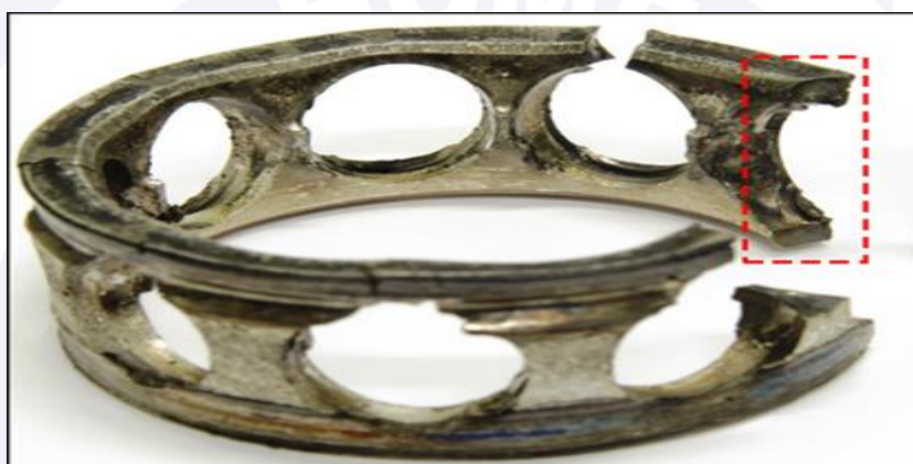
Figura 22 - Vista dos trilhos internos do rolamento nº 2.
