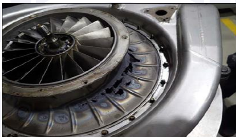
Figura 14 - Danos na área do compressor.
