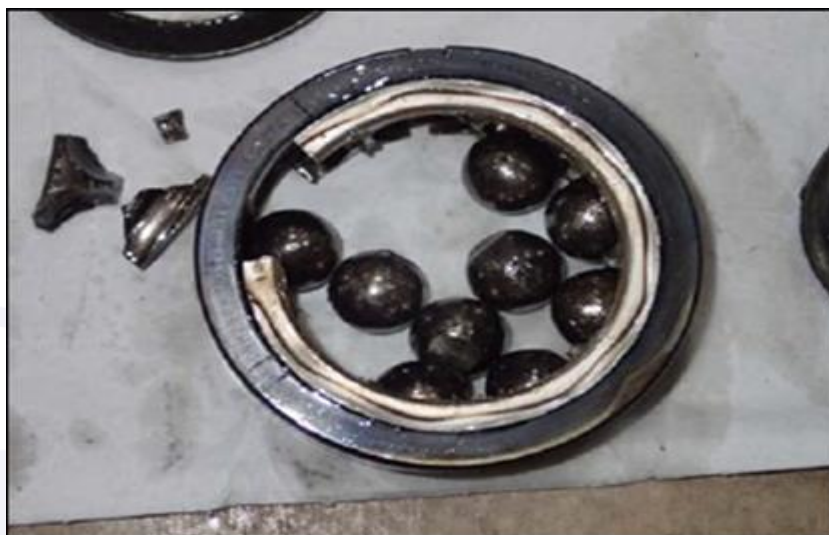
Figura 10 - Rolamento nº 2 após ser retirado da aeronave.
