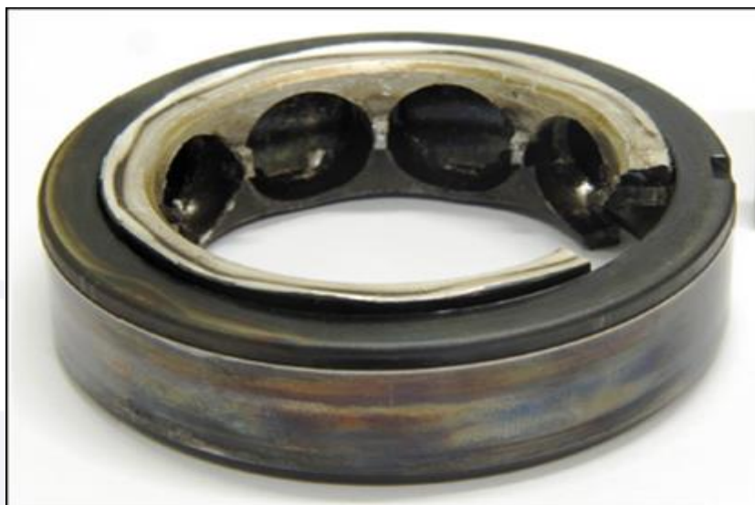
Figura 18 - Vista geral do rolamento nº 2 e dos danos em seu trilho.
