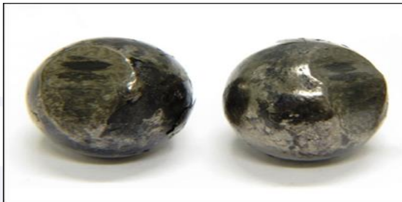
Figura 21 - Vista dos danos causados às esferas do rolamento nº 2.
