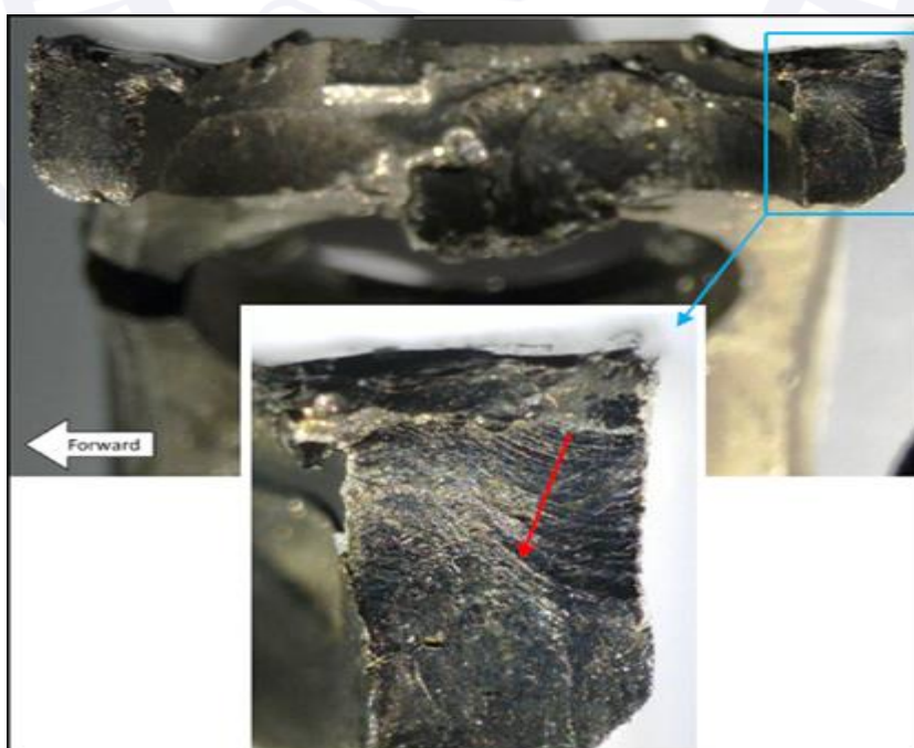
Figura 23 - Vista detalhada dos trilhos fraturados do rolamento nº 2 mostrando indicações macroscópicas consistentes com a progressão de fadiga (seta vermelha).
