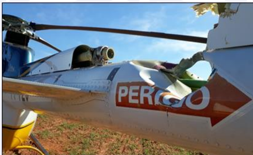
Figura 7 - Detalhe do ponto de impacto das pás do rotor principal contra o boom de cauda.
