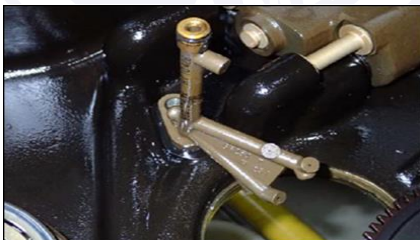
Figura 15 - Piccolo tube em sua posição correta.
