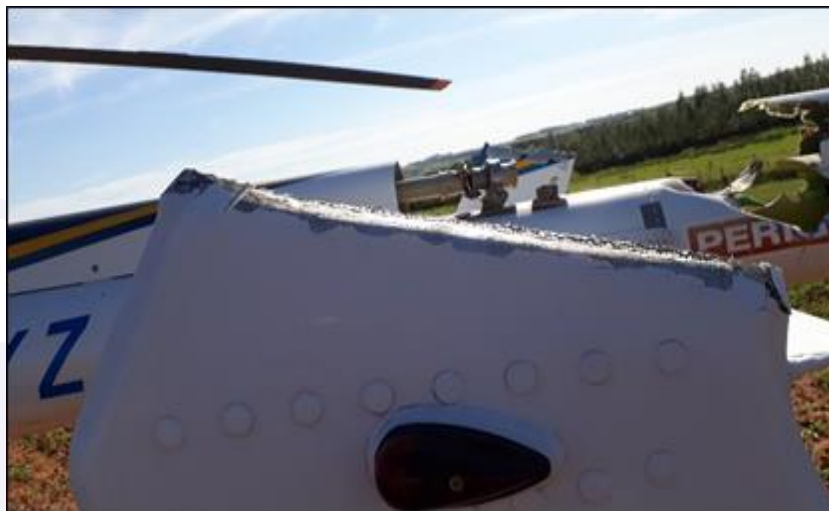
Figura 6 - Detalhe do ângulo de corte do finlet esquerdo provocado pelo rotor principal.
