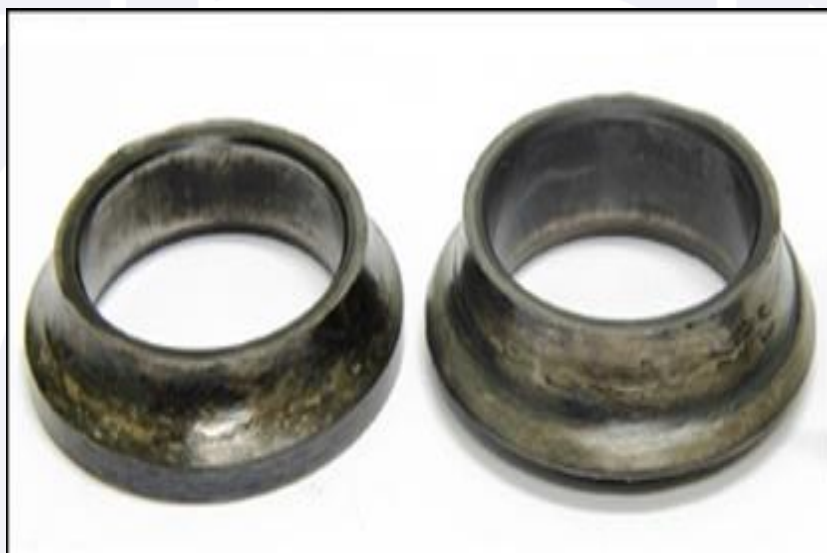
Figura 19 - Vista da condição geral dos anéis internos do rolamento nº 2.
