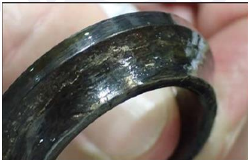
Figura 12 - Marcas de raspagem na pista de rolagem interna do rolamento nº 2.
