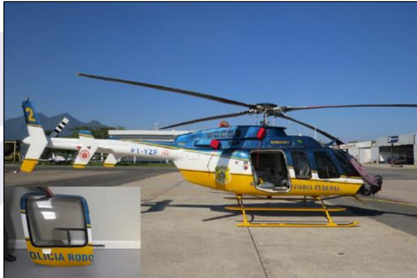
Figura 2 - PT-YZF sem a porta traseira direita. No detalhe, a porta que se despreendeu da aeronave.
