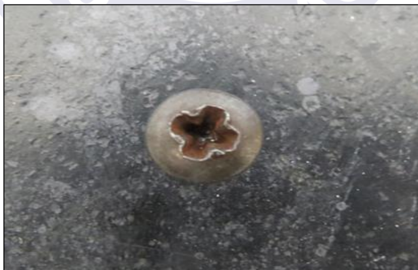
Figura 3 - Parafuso sem PN gravado.
