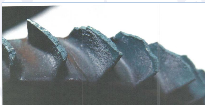
Figura 4 - Detalhe dos danos nas palhetas.
