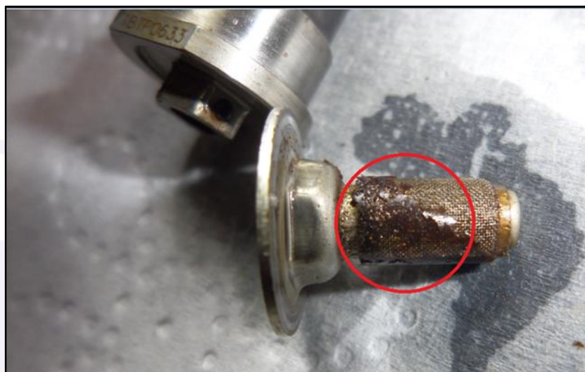
Figura 4 - Fuel nozzle contaminado em destaque.
