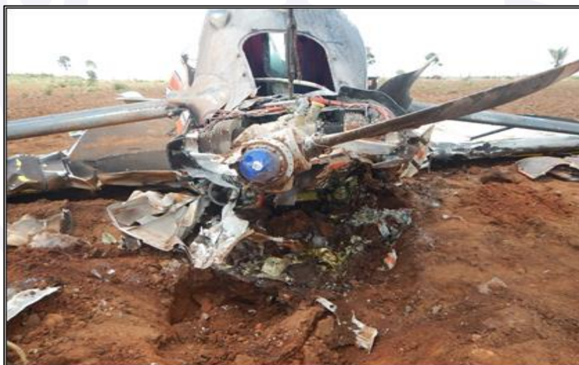
Figura 5 - Hélice com duas pás arrancadas do cubo.
