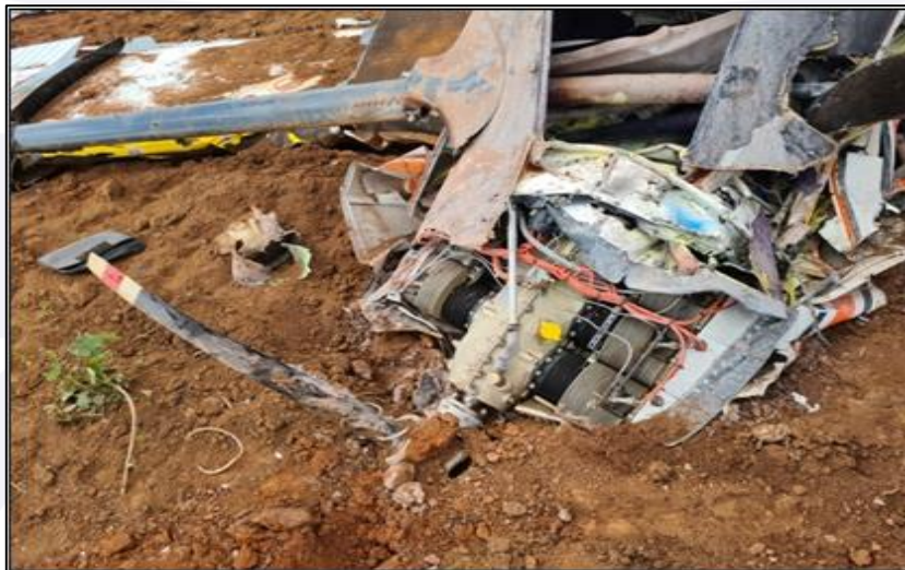
Figura 4 - Motor parcialmente enterrado, com duas pás de hélice arrancadas do cubo de fixação.
