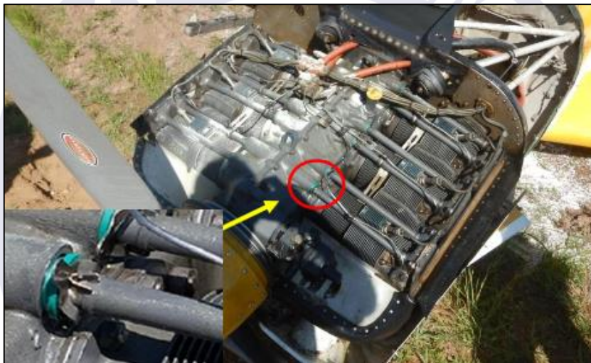
Figura 2 - Local do vazamento do óleo, com destaque para o Spring Shroud Tube fora da posição de travamento.
