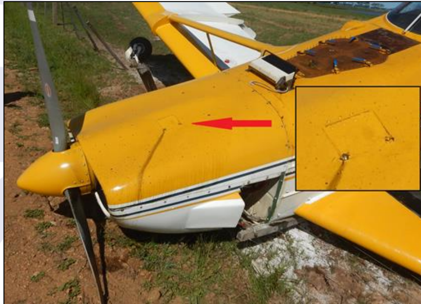
Figura 5 - Detalhe da janela de verificação do nível do óleo do motor.
