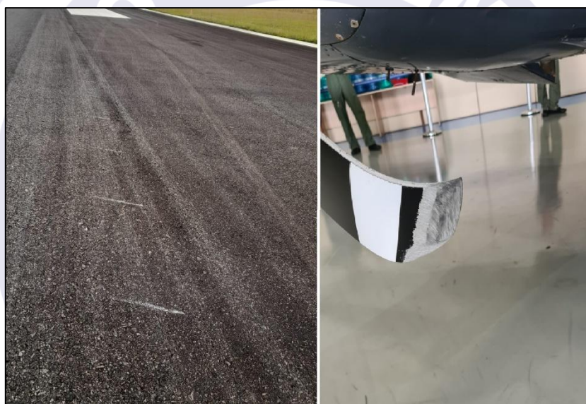
Figura 6 - Marcas na pista e vista de umas das pás danificadas.
