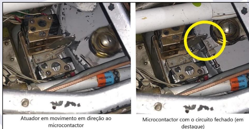
Figura 4 - Braço do atuador e microcontactor da luz verde.
