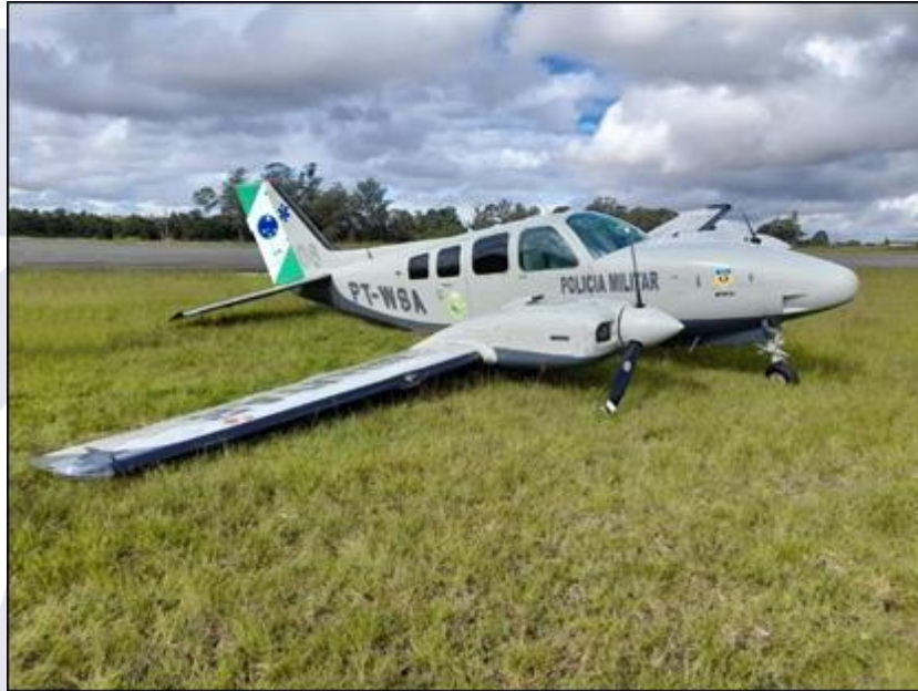
Figura 1 - PT-WSA após a saída da pista com o trem de pouso principal direito recolhido.
