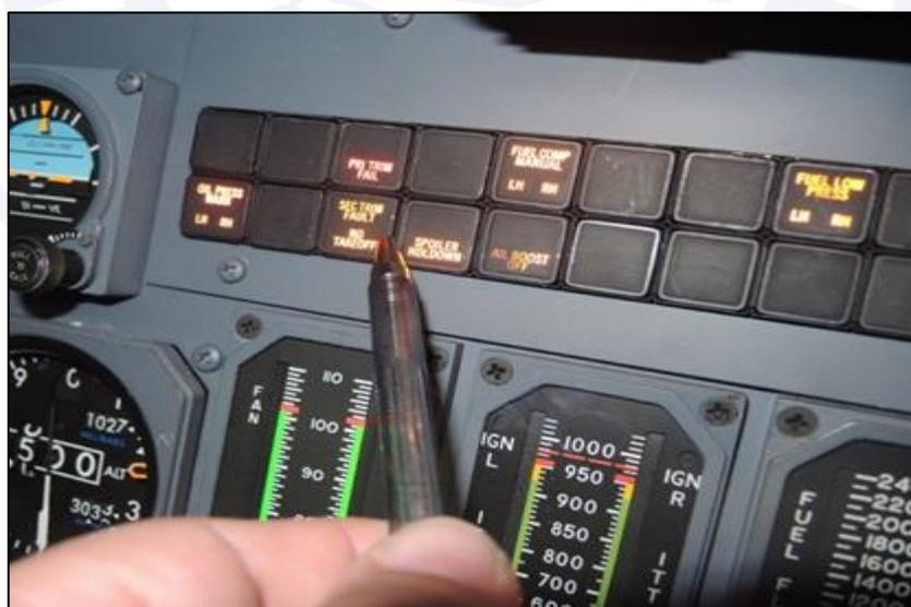
Figura 3 - Luzes *PRI TRIM FAIL* e *SEC TRIM FAULT* no painel de avisos e alarmes.
