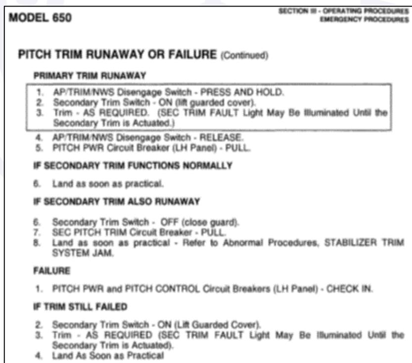
Figura 45 - *Pitch Trim Runaway or Failure Checklist*, página 2 de 2, de acordo com o AFM Revisão 10, de 13AGO2001.
