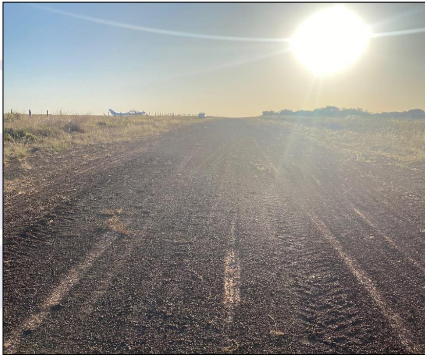
Figura 6 - Marcas curtas de toque na pista e a aeronave ao fundo à esquerda.
