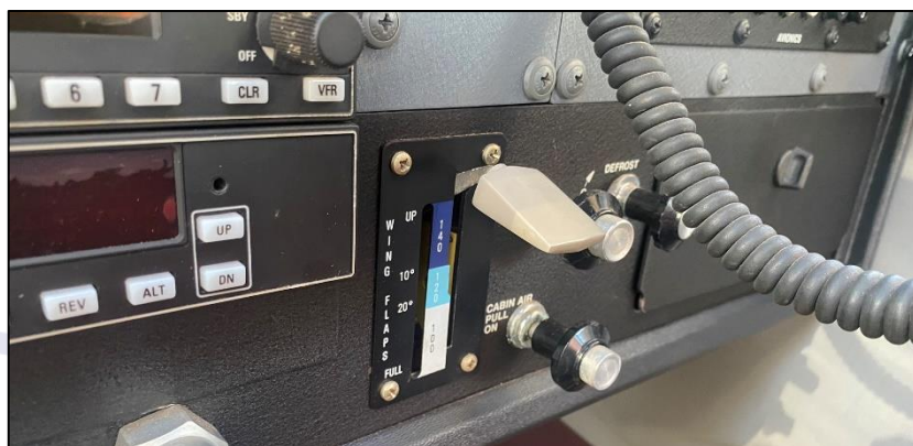
Figura 3 - Comando do flape na posição “up”.
