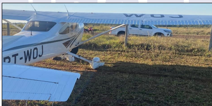
Figura 4 - Superfícies dos flapes recolhidas.
