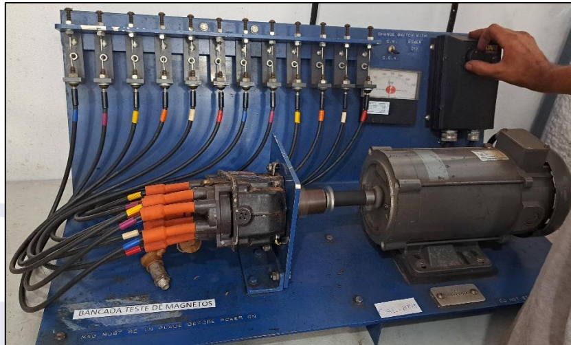
Figura 3 - Teste de bancada do magneto com cablagens novas.
