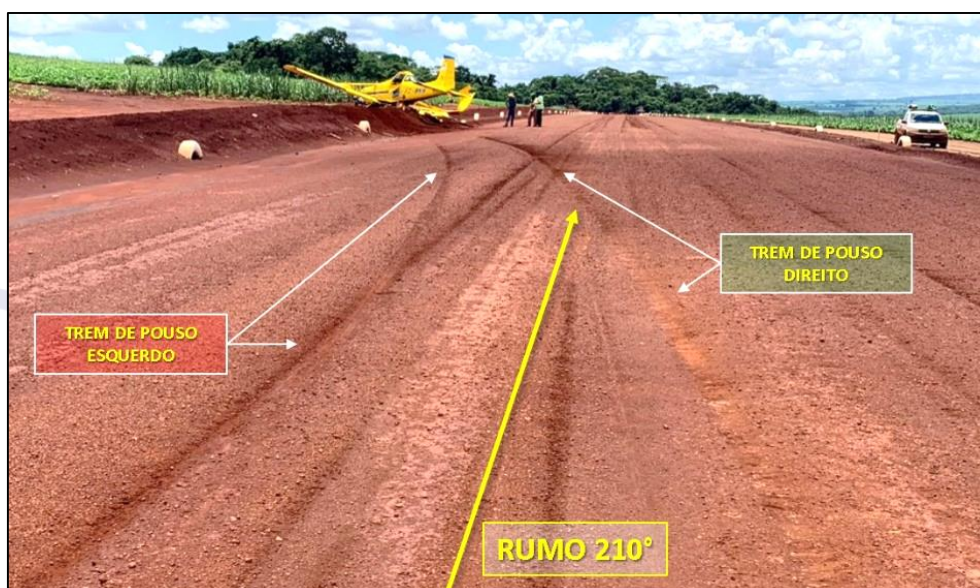
Figura 4 - Marcas de frenagem dos trens principais e posicionamento final da aeronave no barranco da lateral esquerda da área de pouso.
