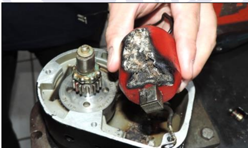
Figura 5 - Parte interna da bobina primária do magneto direito.
