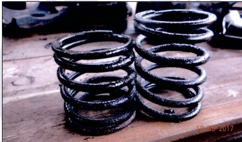
Figura 2 - Molas externas das válvulas do cilindro 4 (a menor é a de admissão).
