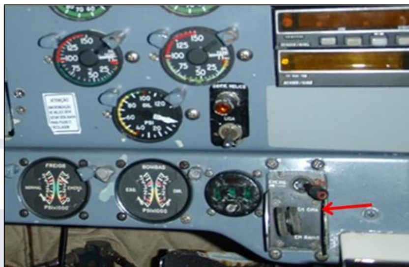
Figura 2 - No detalhe, o comando do trem de pouso na posição em cima.
