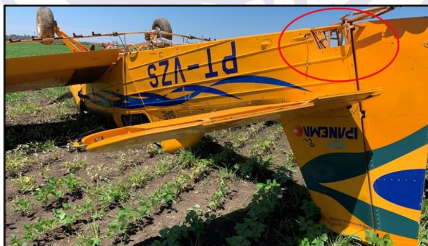
Figura 3 - Detalhe do cabo de comando do leme desconectado.
