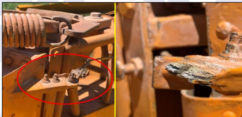
Figura 5 - (ESQ) Lado esquerdo do guinhol sem danos aparentes. (DIR) Lado direito danificado por corrosão.
