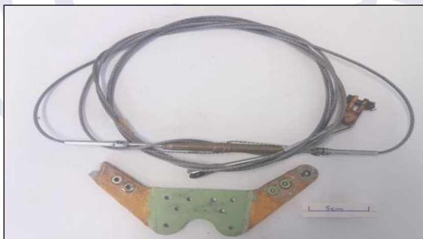
Figura 6 - Vista geral do cabo de comando do pedal direito e guinhol de comando do leme.
