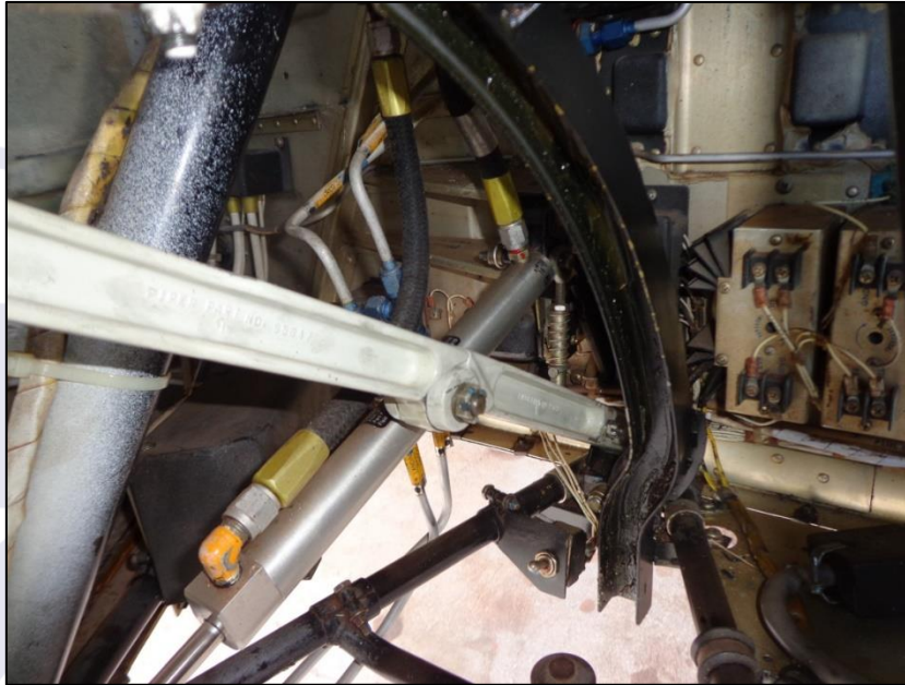
Figura 3 - Ponto de articulação central do braço de arrasto do trem de pouso do nariz (“efeito mola”).
