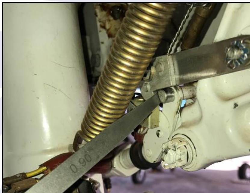
Figura 7 - Medição da folga entre o gancho da trava embaixo e o pino (0,90mm).
