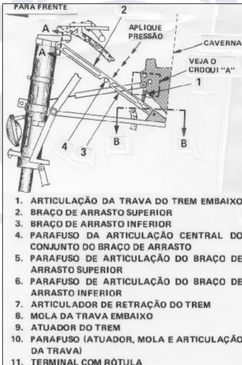
Figura 2 - Identificação do mecanismo da trava embaixo do trem de pouso do nariz.
