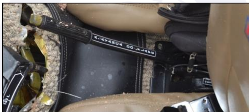
Figura 4 - Vista do interior da aeronave. Verificou-se a posição da alavanca de comando dos flapes na posição totalmente recolhidos.
