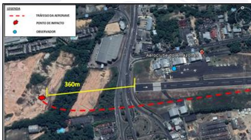
Figura 1 - Croqui do acidente, mostrando a vista aérea do local do impacto e sua posição em relação à cabeceira 11 de SWFN. A linha tracejada vermelha apresenta o trajeto percorrido pela aeronave até o momento do impacto.
