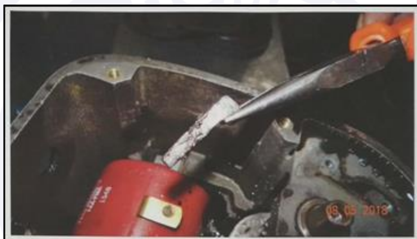
Figura 8 - Vista de uma das travas da bobina solta no interior do magneto esquerdo.
