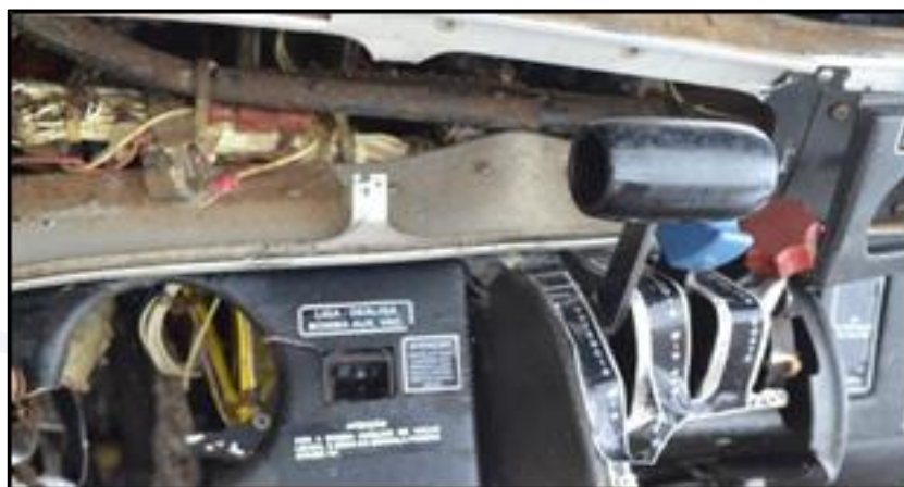
Figura 5 - Vista aproximada do console central, com a caixa de manetes e suas posições.
