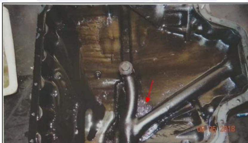
Figura 9 - Vista do interior do cárter do motor. A seta vermelha indica um acúmulo de limalha.
