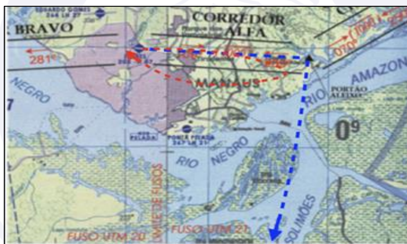
Figura 12 - Rotas Especiais de Aeronaves em Voo Visual na Área de Controle Terminal de Manaus - AM (REA AIC N11/10). O tracejado azul indica a rota autorizada pelo APP-MN, e a seta vermelha indica a rota percorrida pela aeronave até o momento do acidente.
