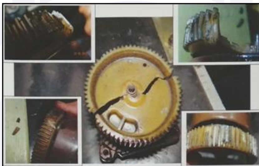
Figura 6 - Vista da engrenagem e os vários dentes do distribuidor do magneto esquerdo danificados por amassamentos ou fraturas.
