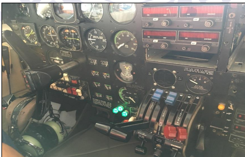
Figura 4 - Visão geral do painel da aeronave e das luzes do trem de pouso.
