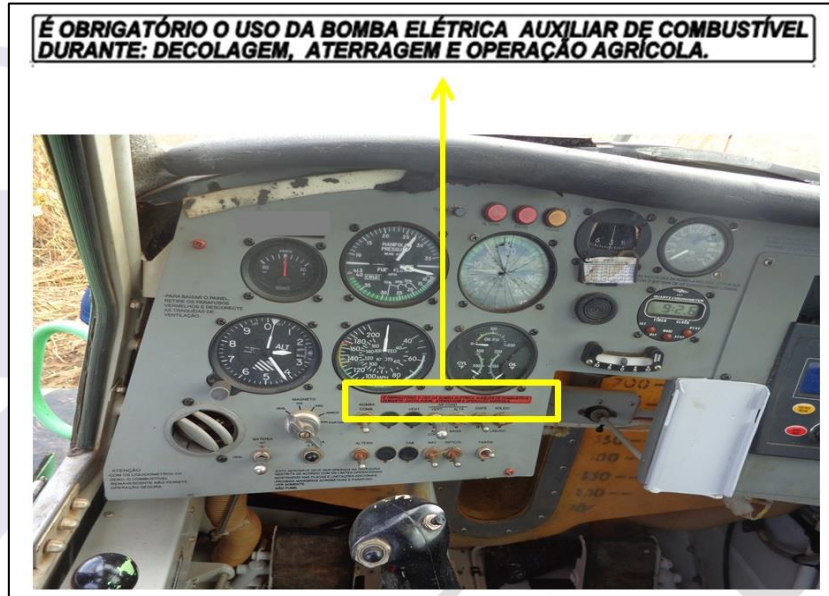
Figura 5 - Painel de instrumentos da aeronave. No detalhe, a inscrição técnica.
