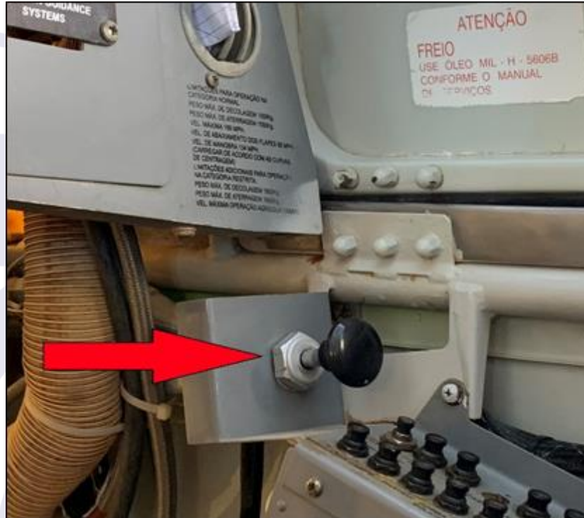
Figura 2 - Condição verificada de alavanca do freio de estacionamento aplicada.
