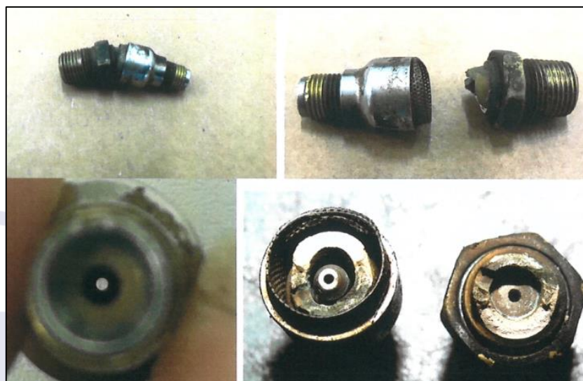
Figura 5 - Vista do bico injetor nº 2 desalinhado e quebrado.
