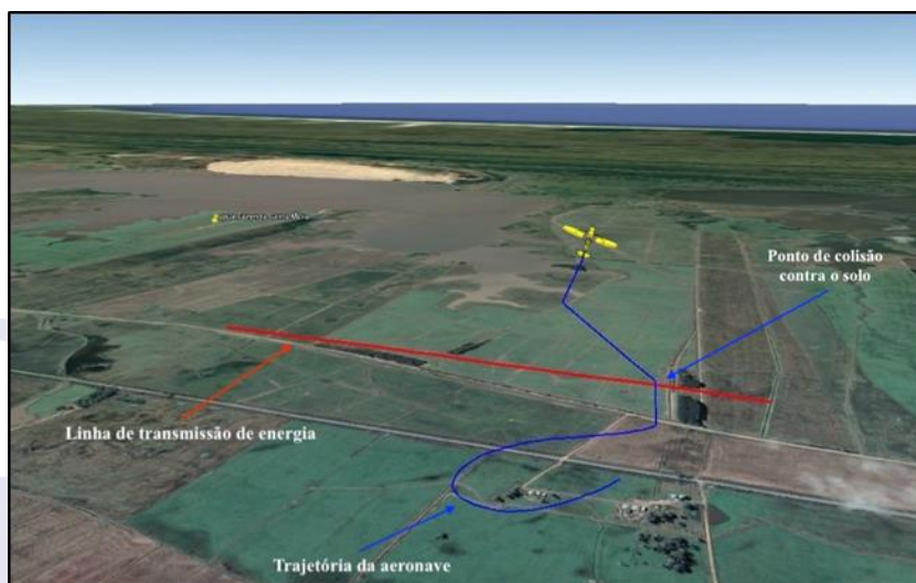
Figura 5 - Cruzamento entre a trajetória da aeronave e a linha de transmissão de energia elétrica.
