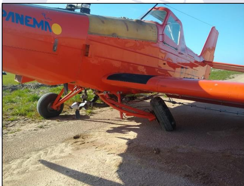
Figura 5 - Danos ao trem de pouso principal esquerdo.
