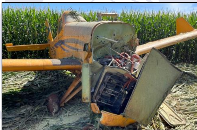
Figura 5 - Imagem do motor suspenso apenas por cabos e mangueiras.
