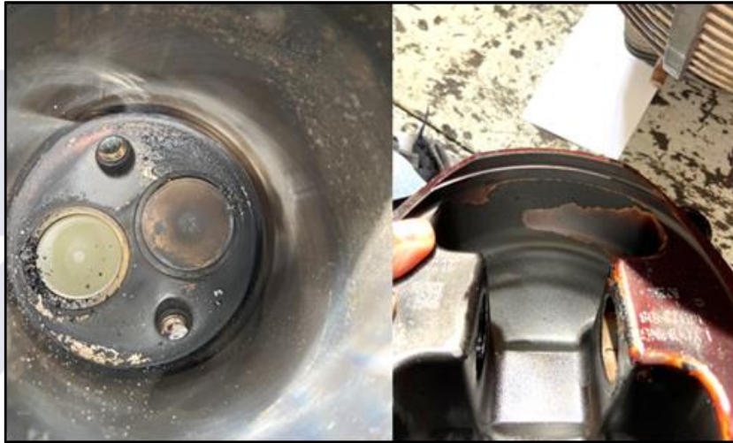
Figura 7 - Resíduos no interior do cilindro nº 5 e indícios de carbonização em seu pistão.
