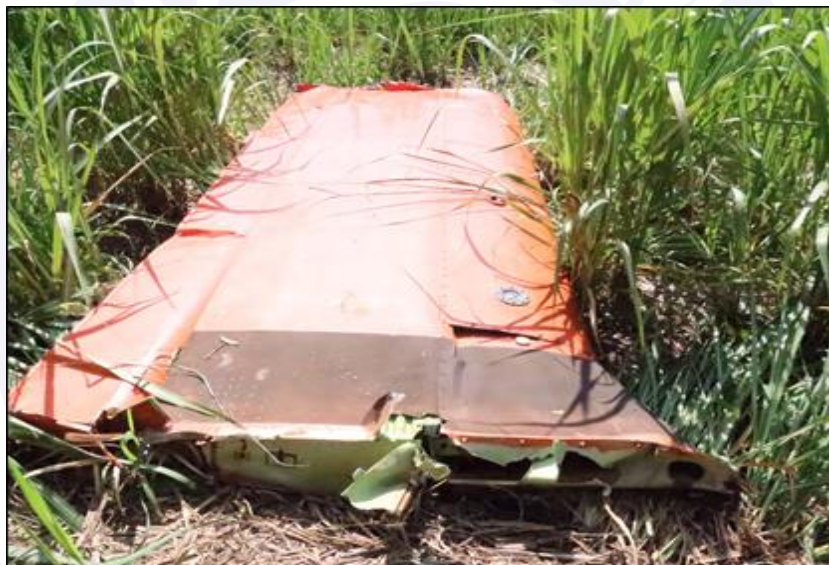
Figura 8 - Visão da semiasa esquerda da aeronave com o extradorso voltado para cima, fraturada em voo e localizada a cerca de 140 m dos demais destroços.
