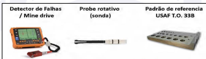
Figura 17 - Extrato do BS 200-057-0008, contendo imagens dos equipamentos necessários à inspeção.
