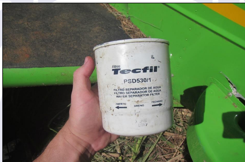
Figura 1 - Filtro de combustível instalado na aeronave.
