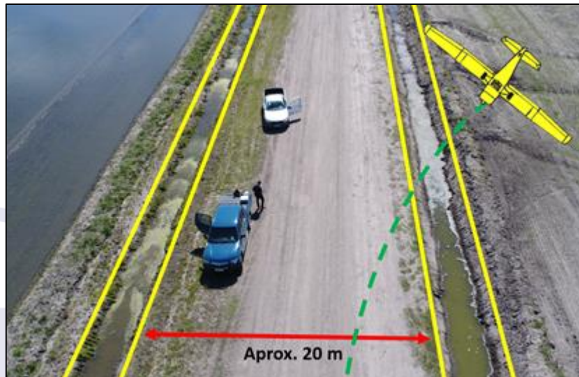
Figura 2 - Vista da área de pouso com destaque das valas nos limites laterais (linhas amarelas), trajetória da aeronave (tracejado verde) e posição final do avião após o capotamento.
