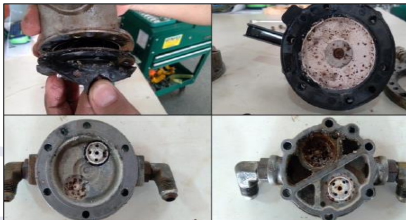
Figura 2 - Bomba de combustível do PT-UFA, com evidências de processo corrosivo.
