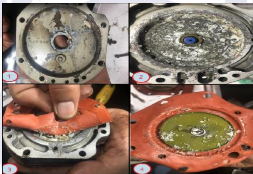
Figura 3 - Servo injetor desmontado no flange do seu diafragma.
