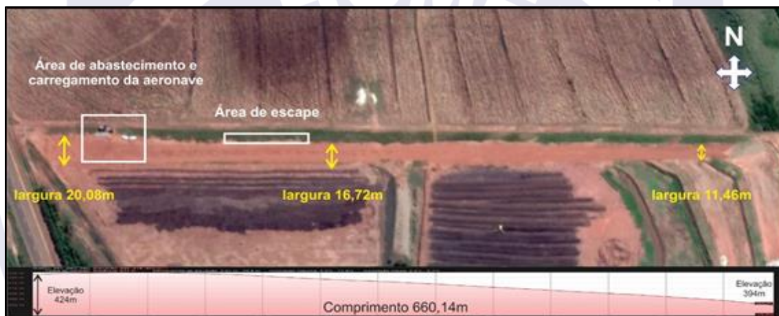
Figura 4 - Croqui dos perfis horizontal e vertical da área de pouso para uso aeroagrícola.
