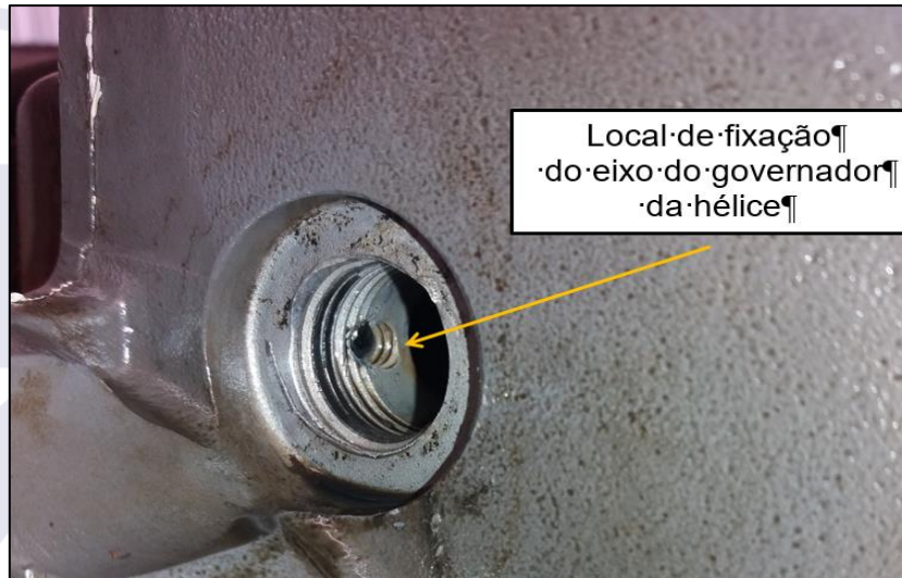
Figura 6 - Detalhe do local onde é aplicado o plug com a indicação do local onde o parafuso fixa o eixo do governador de hélice.
