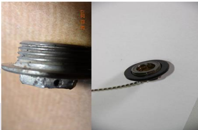
Foto 8 - Comparação da peça que se soltou da aeronave (direita) com uma peça original sem desgaste
