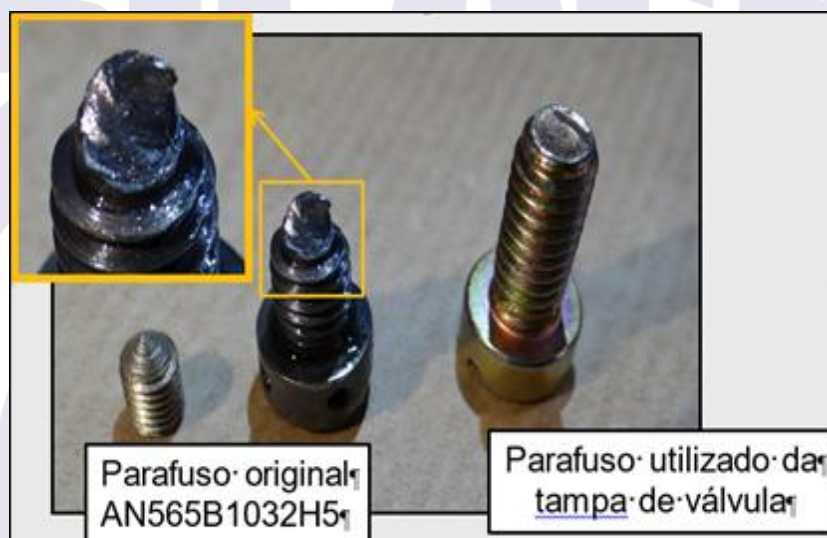
Figura 4 - Comparação entre o parafuso instalado (centro) com o parafuso previsto pelo parts catalog do fabricante (esquerda).
