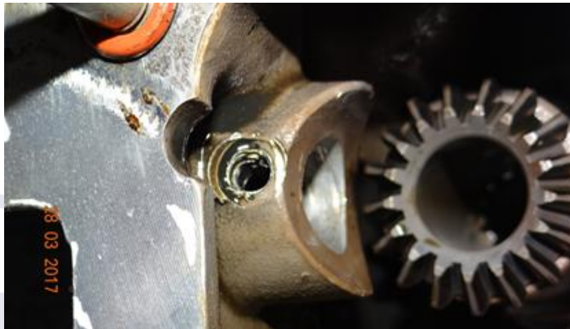
Figura 3 - Vista do alojamento do parafuso após a sua remoção.
