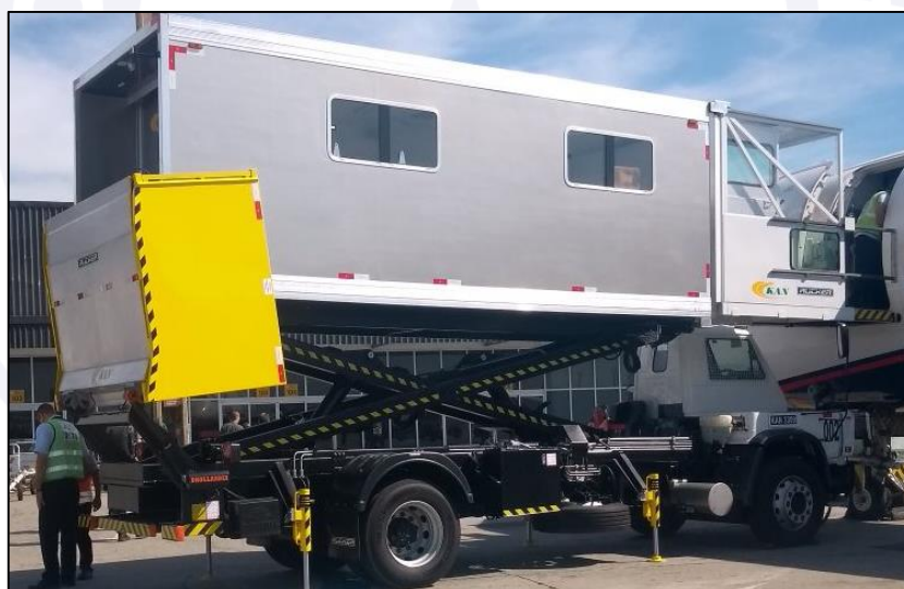
Figura 7 - Imagem de um equipamento Ambulifit utilizado para embarque e desembarque de passageiros, com dificuldades de locomoção, em SBGR.
